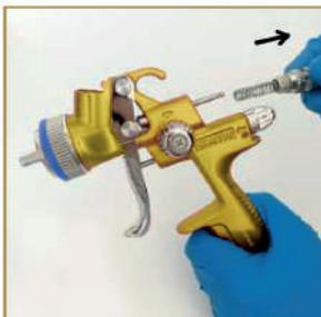
1 - Lors du nettoyage du pistolet, retirez d'abord l'aiguille de peinture
