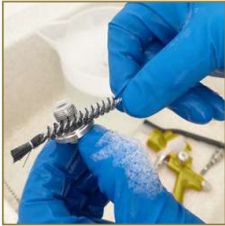
11 - Nettoyer avec les goupillons la buse de chaque côté.
