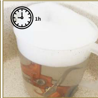
3 - Laissez tremper le pistolet pendant 1h.
