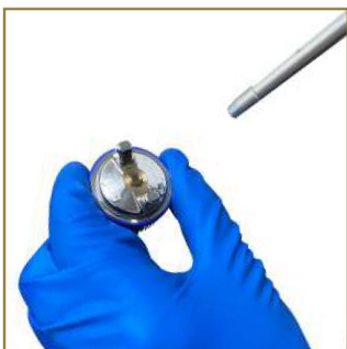
14 - Rincez à l'eau claire le corps du pistolet et le canal de peinture.
