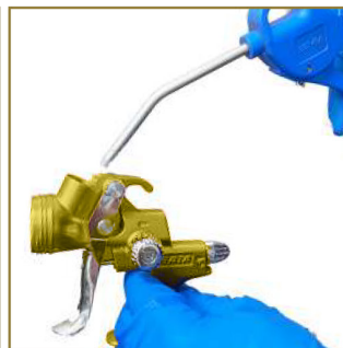
15 - Séchage à l'aide d'une soufflette.
