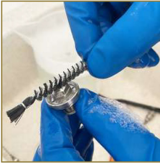
11 - Nettoyer avec les goupillons la buse de chaque côté.
