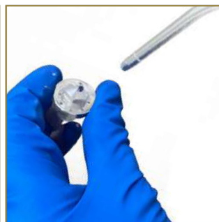
17 - Séchage de la buse.
