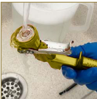
14 - Rincez à l'eau claire le corps du pistolet et le canal de peinture.
